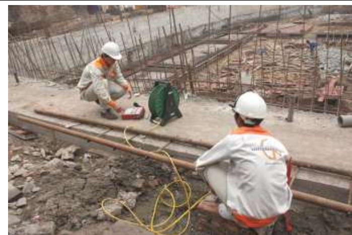
**Chùm ảnh 9:** Quan trắc chuyển dịch ngang tường vây bằng Inclinometer.
